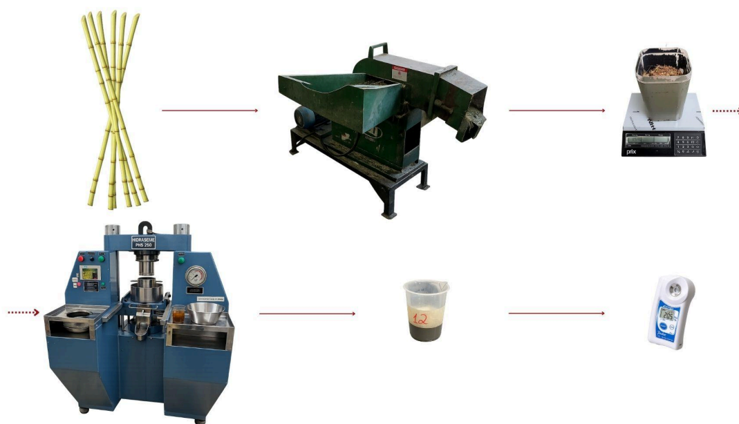
Figura 1. Esquema sequencial da trituração dos colmos em desfibrador, pesagem da amostra, extração do caldo em prensa hidráulica e determinação dos sólidos solúveis totais (SST) em refratômetro digital.
